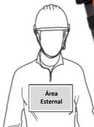
La argolla esternal está especialmente diseñada para conectar un dispositivo anticaídas automático de progresión vertical. Diseñado para progresión en torres de telecomunicaciones, de alta tensión y en todo trayecto ascendente o lateral que requiera protección permanente ante los riesgos de trabajos en altura.
